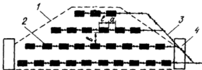
Рис. 4. Схема размещения удлиненных накладных зарядов по площади вруба:
